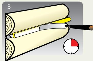
Еще одним важным элементом в подготовке деревянных поверхностей к финишным покрытиям – является **грунтование**. Чаще всего специальные грунтовки по дереву одновременно являются и антисептиками, продлевая сроки службы древесины и защищая ее от образования плесени, грибков и вредного воздействия окружающей среды.
