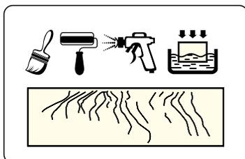
При незначительном повреждении для профилактики заражения древесины состав наносят кистью, валиком, распылителем или методом окунания.
